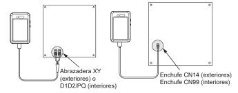
2. Conecte el cargador portátil en el Kit Bluetooth. Encienda el panel de control principal y active el interruptor de potencia del Kit Bluetooth. Si "PCB" permanece encendido, la comunicación entre el Kit Bluetooth y el dispositivo es normal.
