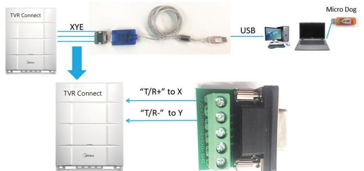
Use el convertor del puerto serie USB para conectar el puerto XYE para la conexión entre el software y los dispositivos, en donde X se conecta a RS485A, e Y se conecta a RS485B.
