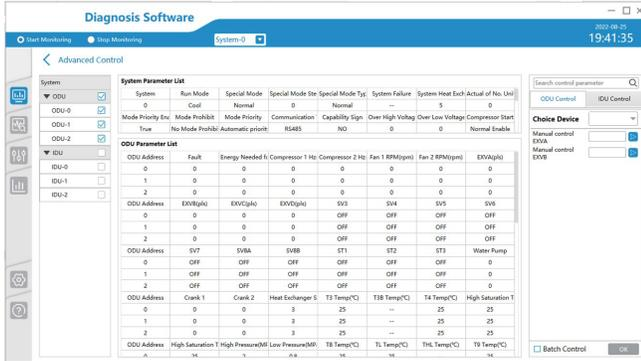
Luego, seleccione el dispositivo de la lista desplegable, ingrese el valor de control correspondiente en el elemento de control de parámetros correspondiente, haga clic en el botón Enviar para enviar el comando de control, o haga clic en "Batch Control" para enviar el comando para múltiples equipos y parámetros. Luego de la transmisión, aparecerá el siguiente mensaje.
