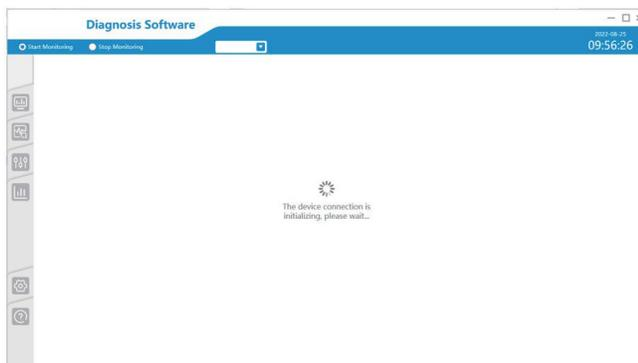
Durante la inicialización del dispositivo conectado, el software buscará automáticamente la información del sistema refrigerante. Si el puerto serie especificado no está configurado para la comunicación, el software automáticamente sondeará todos los puertos serie hasta encontrar uno que pueda conectarse al dispositivo.
