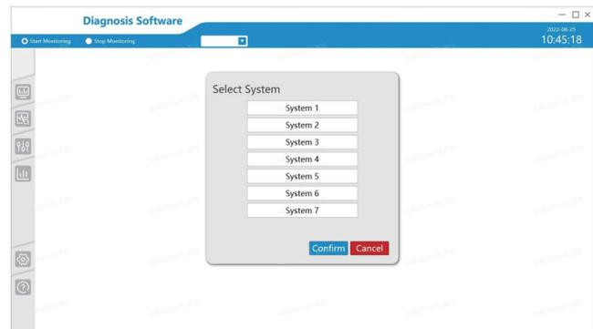
Luego de seleccionar el sistema, podrá consultar la cantidad de unidades interiores y exteriores que tiene el sistema refrigerante. Si el software funciona normalmente, permanecerá en el menú de descripción del sistema de la interfaz principal, se iluminará el ícono con fondo azul y se mostrará la lista de dispositivos. La interfaz es la siguiente.
