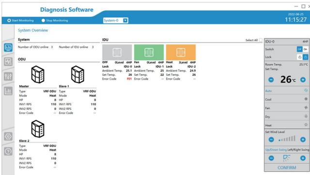
A la derecha de la interfaz de descripción del sistema, hay un panel de control de unidad interior simple que puede configurar funciones como encendido/apagado, temperatura, modo, nivel de viento, oscilación y bloqueo para la unidad interior seleccionada. El estado "locked" en el panel derecho significa que el controlador remoto y el controlador cableado están bloqueados.
