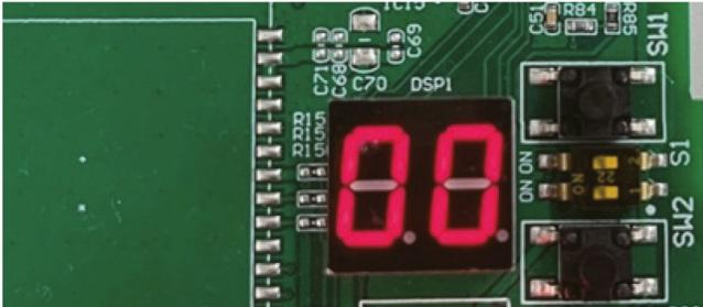
Cuando se encienda, la pantalla muestra la versión de software. Cuando el software se ejecute correctamente, se mostrará el número de IDU y ODU en forma alternada.
