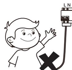
El aire acondicionado debe tener una conexión a tierra. Verifique que el cable de conexión a tierra esté conectado en forma segura y sin roturas. No conecte la línea de conexión a bidones de combustible, tuberías de agua, pararrayos o cables terrestres telefónicos.
