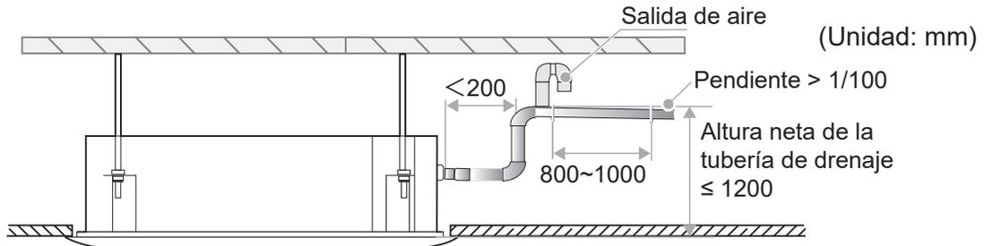
Método para conectar la tubería de drenaje para una unidad simple
