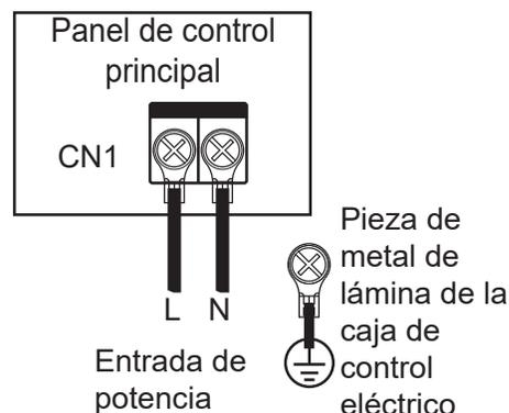
**A** No vincule ni conecte el cable de alimentación. La vinculación y conexión del cable de alimentación puede causar su calentamiento, e iniciar un incendio.
