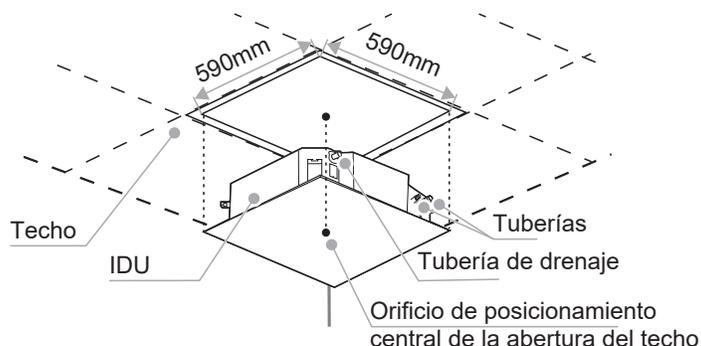
2. Confirme la posición del gancho de instalación de acuerdo con los orificios de los ganchos de instalación ubicados en las cuatro esquinas del cartón de montaje.
