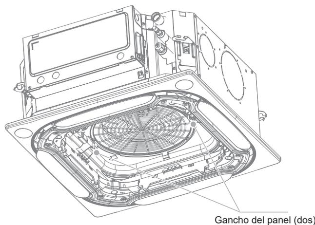
3. Ajuste los tornillos debajo de los ganchos del panel hasta que el espesor de las esponjas de sellado 1 y 2 entre la IDU y la salida del panel se reduzca a unos 4-6 mm. El borde del panel debe tener un buen contacto con el techo.
