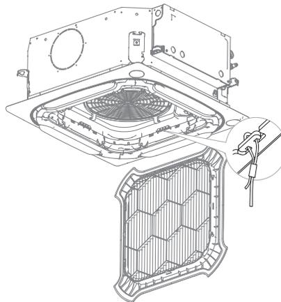
3. Instale nuevamente la rejilla de succión en la posición correspondiente, y presione levemente en la posición de la abrazadera de la rejilla para garantizar que la hebilla esté totalmente enganchada en la ranura del panel, y que la rejilla esté en la posición cerrada.
