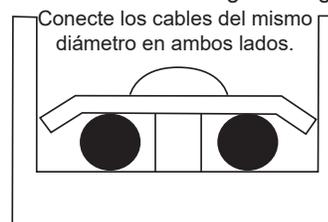
**D** No presione los cables de alimentación del mismo diámetro de cable sobre el mismo lado de la terminal. No use dos cables de alimentación de diámetros de cable diferentes para el mismo bloque de terminales; de lo contrario, pueden aflojarse fácilmente debido a la presión irregular y causar accidentes, tal como se muestra en la siguiente figura.
