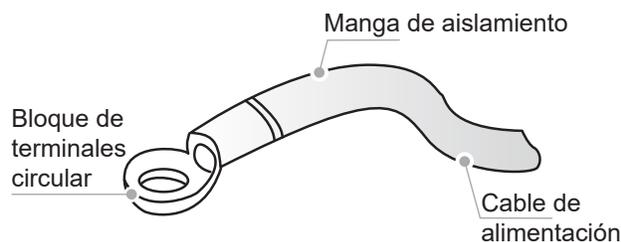
**C** Si no es posible asegurar el bloque de terminales circular aislado por limitaciones del sitio, conecte los cables de la fuente de alimentación del mismo diámetro en ambos lados del bloque de terminales de alimentación eléctrica de la IDU, como se muestra en la siguiente figura.
