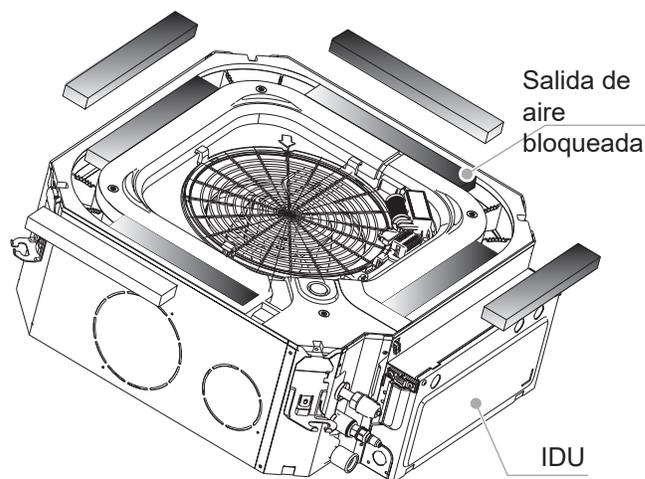
Use un cuchillo para cortar el bloqueo del material de embalaje.
