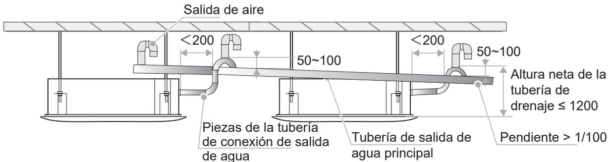
Las tuberías de drenaje desde múltiples unidades se conectan a la tubería de drenaje principal para la descarga a través de la tubería de aguas residuales.
