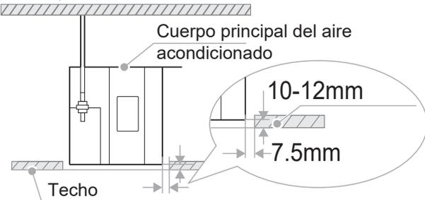
**C** Luego de ajustar la posición y nivel del cuerpo principal, ajuste las tuercas del gancho de montaje para fijar el aire acondicionado.
