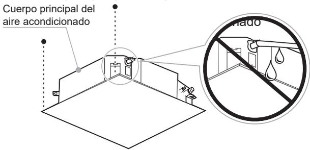
**B** Ajuste la posición del cuerpo principal para garantizar que el intervalo de los cuatro lados del techo esté nivelado; y la superficie inferior del cuerpo principal debe estar empotrada desde la superficie inferior del techo por unos 10-12 mm.
