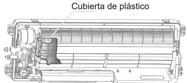
3 Extraiga el motor para su mantenimiento o reparación.
