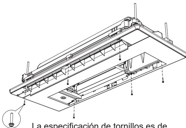
La especificación de tornillos es de M4X22, y hay 6 tornillos para los modelos 18-36. Hay siete modelos 45-71, que se incluyen en los accesorios adjuntos.
