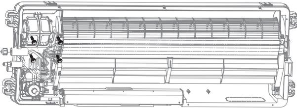
2 Extraiga la cubierta de plástico del motor.
