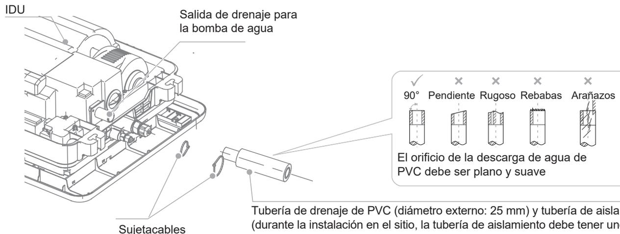
Tubería de drenaje de PVC (diámetro externo: 25 mm) y tubería de aislamiento (durante la instalación en el sitio, la tubería de aislamiento debe tener unos 50 mm más que la tubería de descarga de agua PVC para garantizar que haya un revestimiento suficiente en los extremos para el aislamiento)
