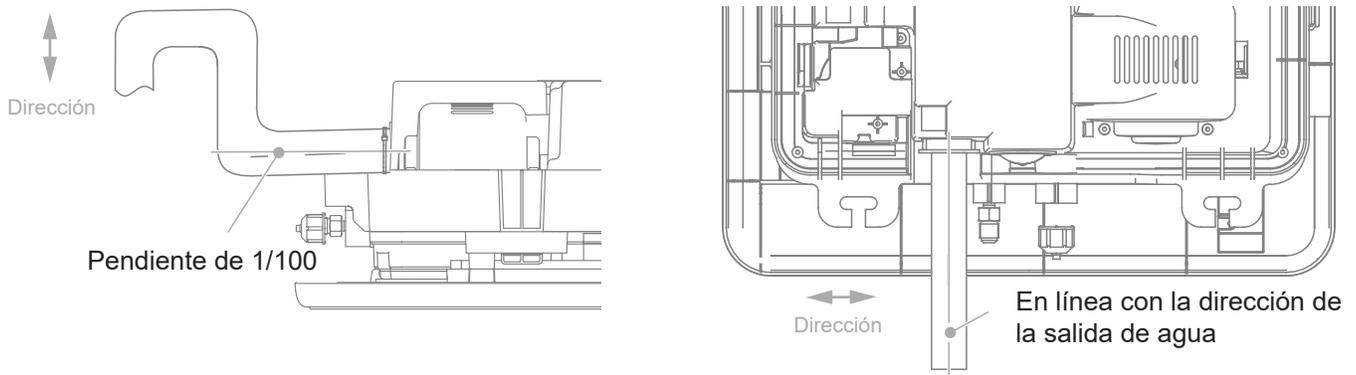
4. Al conectar la tubería de drenaje, no jale de ella por la fuerza, o podría aflojarse. La longitud lateral de la tubería de drenaje debe ser dentro de los 20 m, y se debe colocar un punto de soporte cada 0,8-1,0 m para evitar la resistencia del aire causada por la deformación de la tubería de drenaje. La tubería de drenaje debe contar con un punto de soporte cada 1,5 - 2,0 m.
