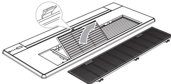
3. Abra el deflector de viento y extraiga los tres tornillos para ocultar la cubierta;
