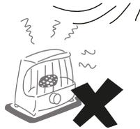
La altura de la instalación del aire acondicionado debe ser de al menos 2,5 m por sobre el piso para evitar los siguientes riesgos:
