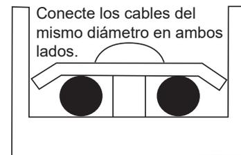
**D** No presione los cables de alimentación del mismo diámetro de cable sobre el mismo lado de la terminal. No use dos cables de alimentación de diámetros de cable diferentes para el mismo bloque de terminales; de lo contrario, pueden aflojarse fácilmente debido a la presión irregular y causar accidentes, tal como se muestra en la siguiente figura.
