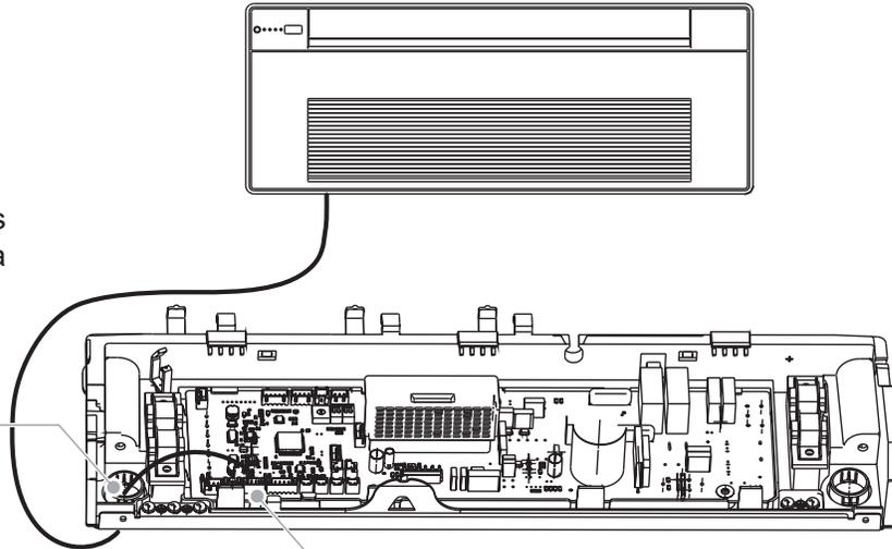
El enchufe del cable de 4 polos del panel está conectado a CN30 del panel de control principal
