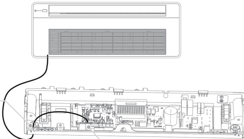
El enchufe del cable de 4 polos del panel está conectado a CN30 del panel de control principal
