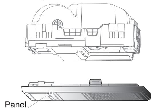
**2** Extraiga los componentes de la bandeja de goteo de agua hacia abajo.
